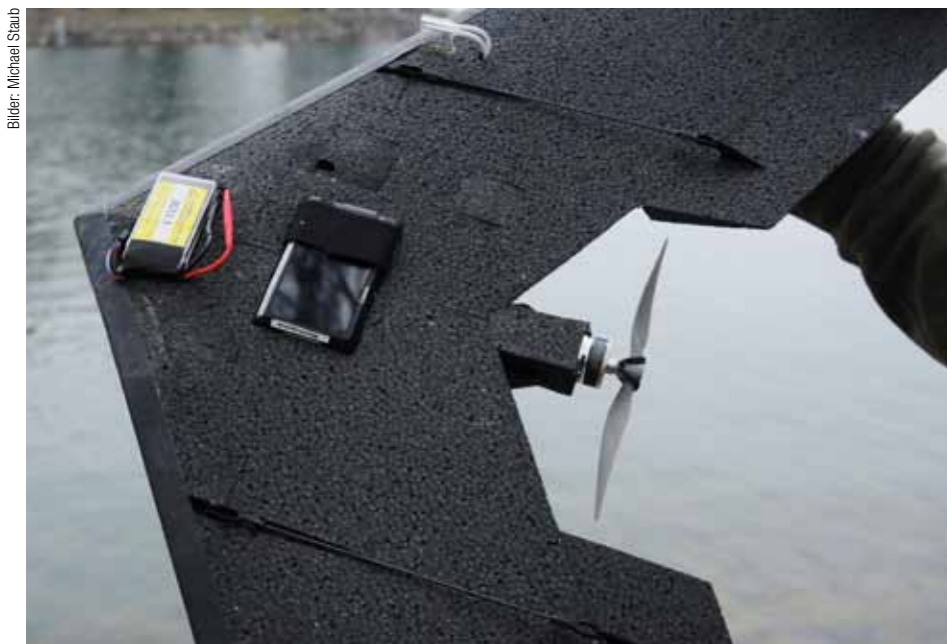
Die «Sensefly»-Drohne ist mit Akku, Kamera und Propeller bestückt.
